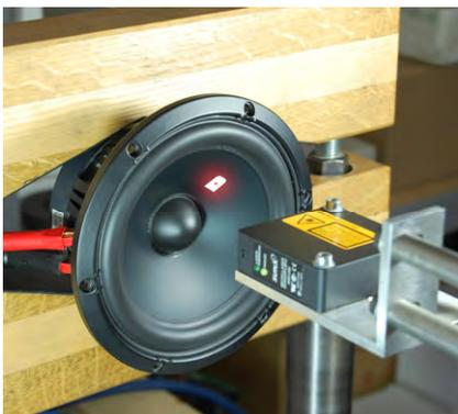
Mesure des excursions par capteur laser de haute précision
