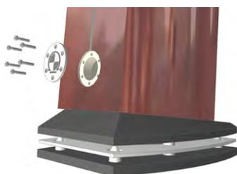
Les colonnes GT2 et GT3 sont équipées à leur base d'une cavité de sablage (sable non fourni). Le remplissage (environ 3L / 5 kg pour GT2, environ 4L / 7kg pour GT3) se fait par la face avant en retirant le logo qui assure élégamment la fonction d'orifice. Une fois remplie de sable fin et bien sec, cette cavité renforce la stabilité de l'enceinte et amortit les vibrations parasites de l'ébénisterie.
