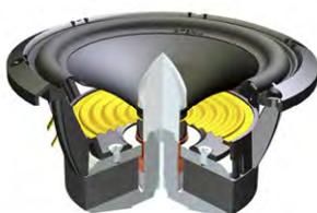
Ce haut-parleur de 15cm de diamètre est utilisé dans les colonnes GT3 et couvre la bande bas medium - medium (250Hz-2500Hz). Il est équipé d'une ogive anti tourbillonnaire en aluminium, usinée dans la masse. Son profil particulier optimise la directivité du haut-parleur et améliore le refroidissement radiatif du moteur directement à l'extérieur de l'enceinte. Cette unité a une sensibilité native élevée
