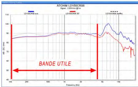
Appuyés par des simulations (méthode des éléments finis) et par des mesures par interférométrie laser, nous avons optimisé les nombreuses interactions et affiné la géométrie de l'ensemble des pièces mobiles. La réponse en fréquence des haut-parleurs se
