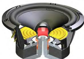
Ce haut-parleur de 15cm de diamètre est utilisé dans les bibliothèques GT1 ainsi que les colonnes GT2 et couvre l'intégralité de la bande grave medium (20Hz-2500Hz). La somme de ses caractéristiques décrites précédemment (géométrie des suspensions, nature de la membrane, géométrie des pièces polaires,...) lui confère les facultés de reproduire tout le registre grave jusqu'au haut medium avec grande aisance, sous des taux
