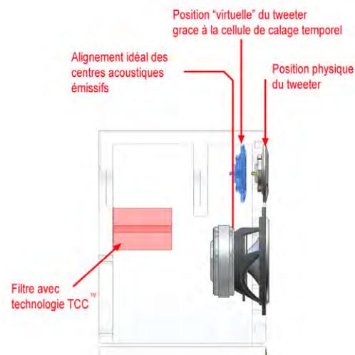
À l'écoute, la technologie TCC™ se traduit par l'obtention d'une scène sonore réaliste et « holophonique » à souhait. La notion de plans sonores est parfaitement respectée et les instruments se positionnent dans l'espace avec une aisance déconcertante et une profondeur inhabituelle. Elle se caractérise également par une parfaite « fusion » entre les différents transducteurs.
