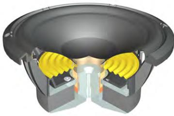
Ce haut-parleur de 18cm de diamètre est utilisé dans les colonnes GT3 et reproduit le registre grave (20Hz-250Hz). Grâce à sa motorisation et à ses suspensions, il est capable d'excursions d'une ampleur et d'une rapidité extrêmes (+/- 8mm linéaires, +/- 11mm max)! Son cône est ouvragé de 8 orifices pour maximiser la décompression du noyau et le refroidissement de la bobine. Sa grande tenue en
