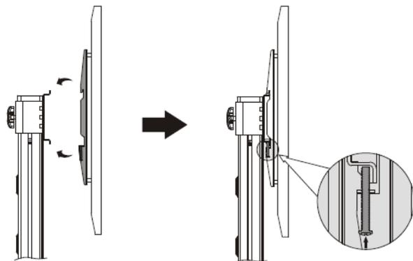
Installez votre écran puis resserrez les 2 vis inférieures des deux bras pour sécuriser l'installation.
