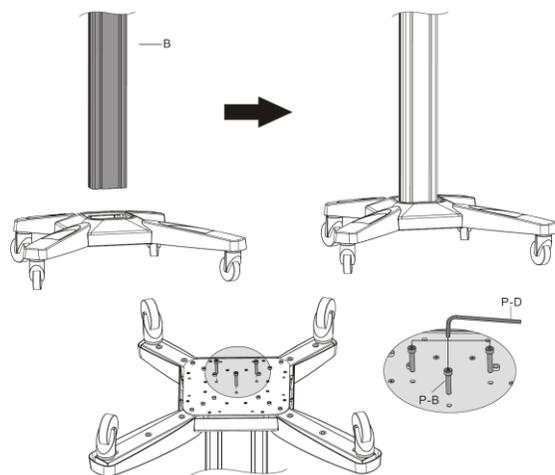
Assemblez la base et la colonne en utilisant les 3 vis P-B.
