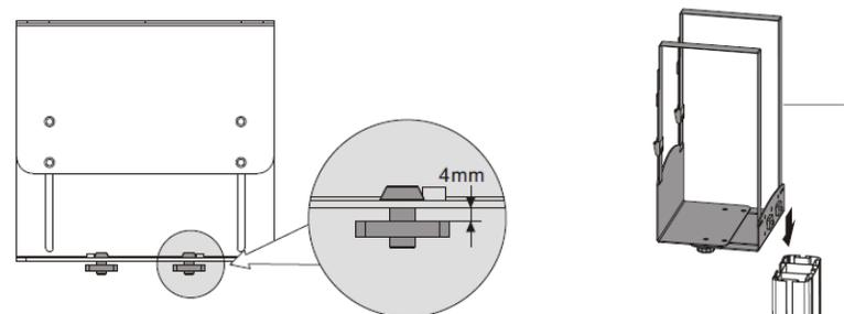
Desserrez les 2 vis pour laisser un espace de 4mm et pouvoir insérer le support.
