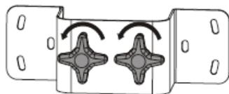
Dévissez les 2 molettes de serrage au dos de la fixation.
