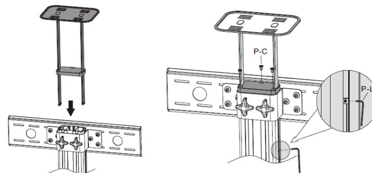
Insérez les 2 tiges le long de la colonne à la hauteur désirée puis serrez les vis pour fixer l'ensemble.
