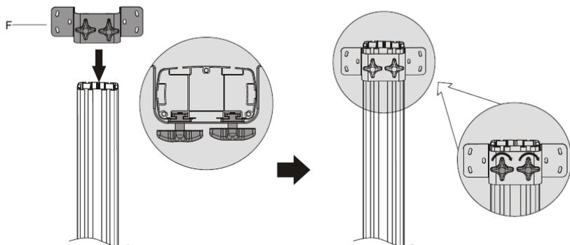
Insérez la plaque de fixation au niveau désiré puis resserrez les deux molettes de serrage.
