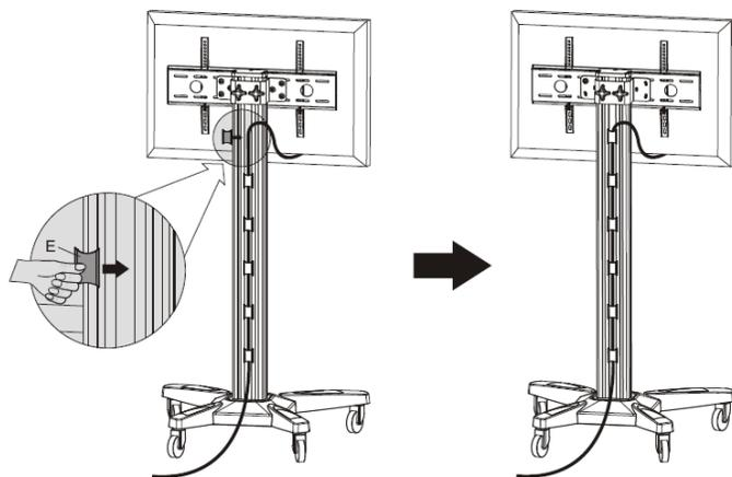
Passez la connectique sur la partie arrière du pied et insérez les caches plastique. L'installation est terminée.
