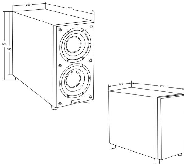
Dimensions avec grille et connecteurs : H428 x L205 x P553 mm
