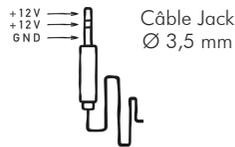
La liaison Trigger doit être réalisée avec un câble jack stéréo Ø 3,5 mm Mâle/Mâle.
