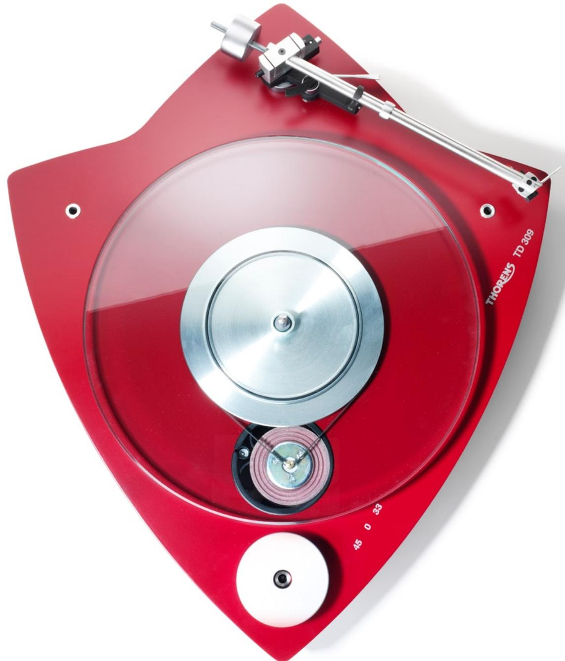
**Das Herzstück des Laufwerks.** Als Antrieb dient dem TD 309 ein Gleichstrommotor, der seine Kraft mit Hilfe eines Flachriemens auf den präzisionsgedrehten Subteller überträgt. Dieser treibt wiederum den Plattenteller aus Quarzglas an. Ein spezieller Kontaktring reduziert dessen Eigenschwingung.
