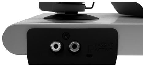
Si vous souhaitez utiliser l'étage phono de votre amplificateur ou un étage phono séparé, réglez l'interrupteur à l'arrière de la platine sur la position Passive. L'étage phono intégré est utilisé s'il est laissé sur la position Active.
