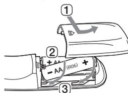
Utiliser des piles AA de 1,5 V. Remplacer les deux piles en les insérant dans la télécommande conformément aux instructions indiquées.
