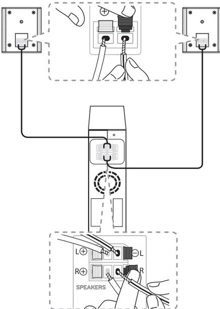
2. Connectez le récepteur sans fil et les enceintes arrière (gauche, droite) aux câbles des enceintes.
