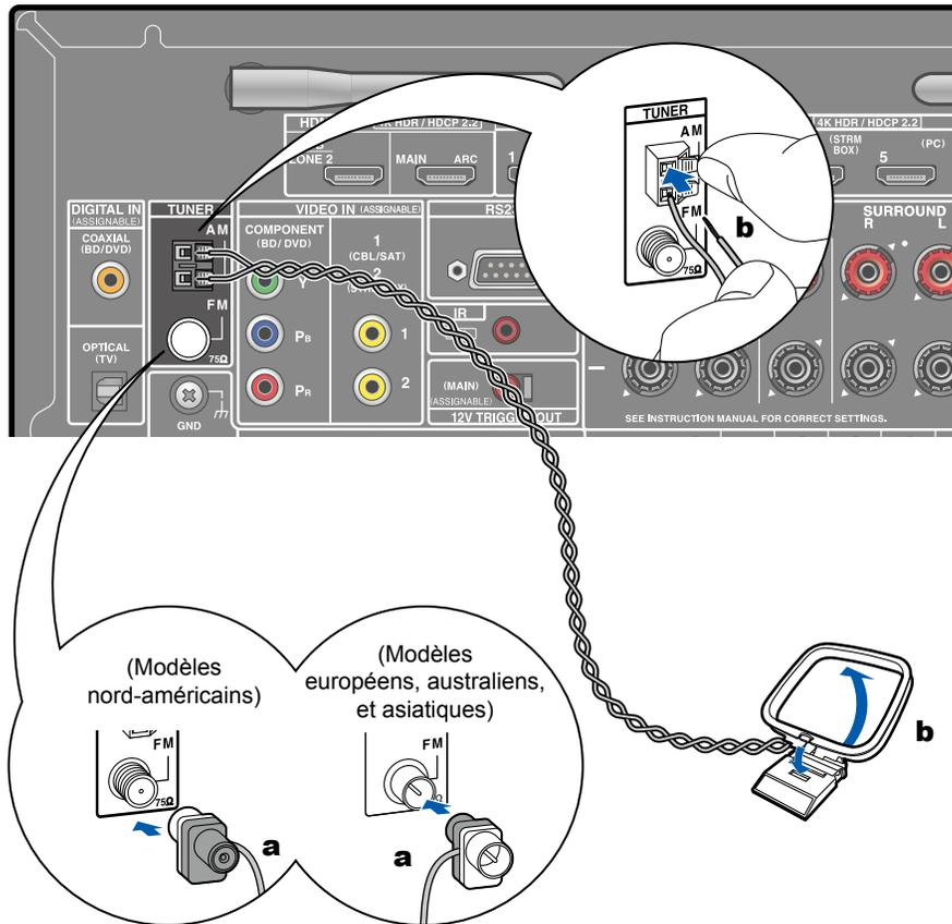
**a** Antenne FM intérieure, **b** Antenne cadre AM
