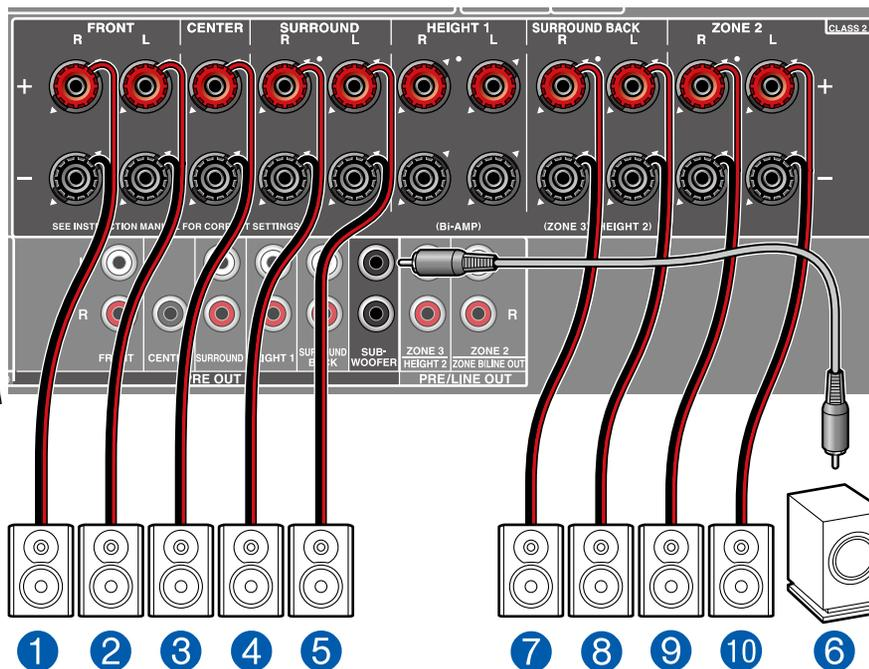
**MAIN ROOM :** Il s'agit de la combinaison d'un système 5.1 et d'enceintes en hauteur avant. Une enceinte en hauteur avant est un type d'enceinte en hauteur. Vous pouvez sélectionner uniquement un jeu d'enceintes en hauteur parmi les trois types suivants pour le raccordement.
