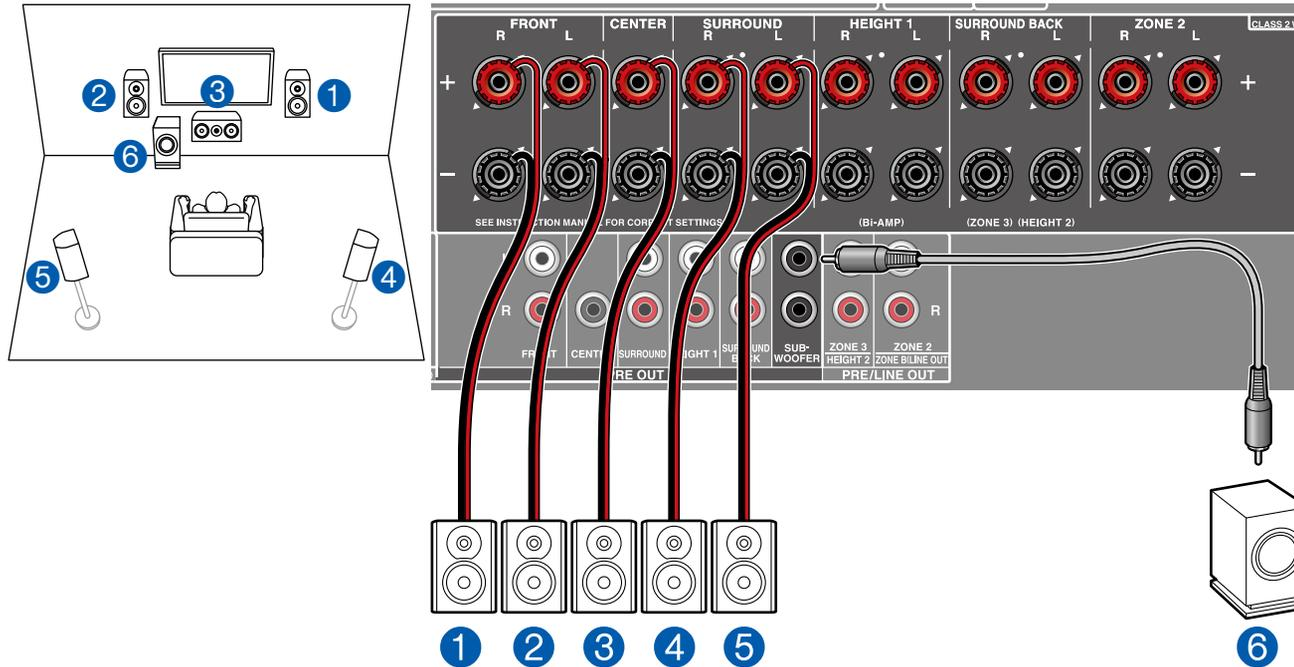
Il s'agit d'un système 5.1 de base. Pour plus de détails sur la disposition d'enceinte, consultez "Installation d'enceintes" (→p19).
