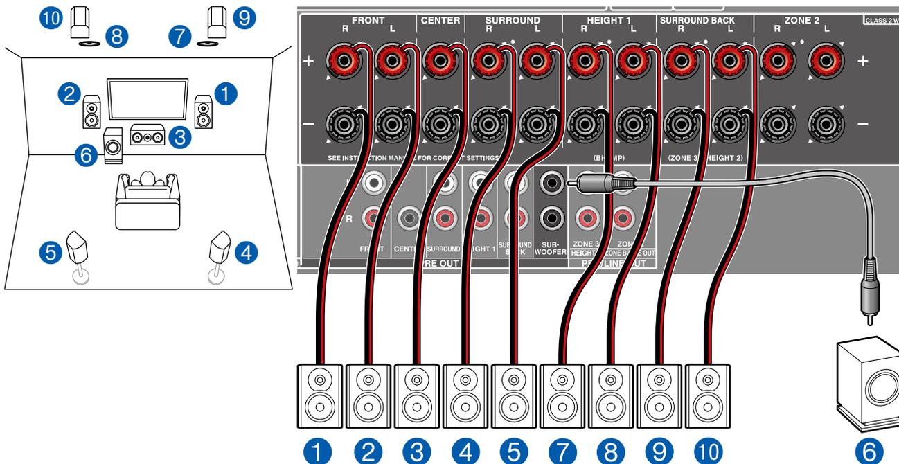
Il s'agit d'un exemple de combinaison d'enceintes pour plafond centrales à l'avant et d'enceintes en hauteur à l'arrière sur le système 5.1. Il est possible de sélectionner les enceintes en hauteur à l'avant parmi les 4 types suivants. Les enceintes en hauteur pouvant être combinées à l'arrière diffèrent selon les enceintes en hauteur utilisées à l'avant.
