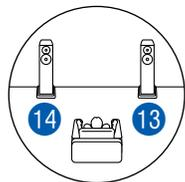
**MAIN ROOM :** Il s'agit d'un exemple de combinaison d'enceintes pour plafond centrales à l'avant et d'enceintes en hauteur arrière à l'arrière sur le système 7.1. Il est possible de sélectionner les enceintes en hauteur à l'avant parmi les 4 types suivants. Les enceintes en hauteur pouvant être combinées à l'arrière diffèrent selon les enceintes en hauteur utilisées à l'avant.
