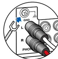
Si la platine disque a un fil de mise à terre, branchez-le à la borne GND de cet appareil.
