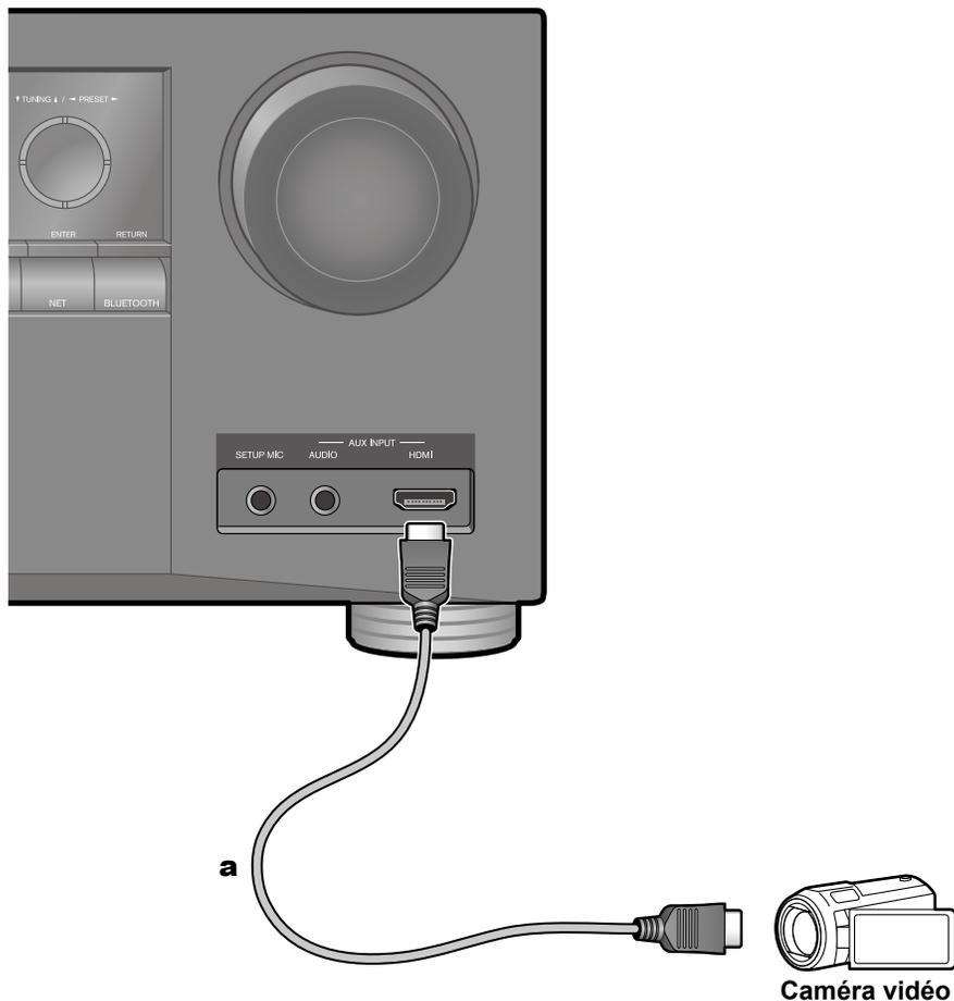
Raccordez une caméra vidéo, etc. à la prise AUX INPUT AUDIO/HDMI sur le panneau frontal à l'aide d'un câble HDMI ou d'un câble à mini-fiche stéréo ( $\varnothing 1/8''/3,5$  mm).
