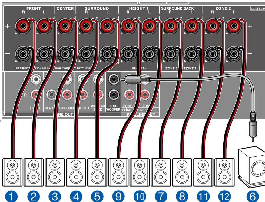
**MAIN ROOM :** Il s'agit de la combinaison d'un système 7.1 et d'enceintes en hauteur avant. Une enceinte en hauteur avant est un type d'enceinte en hauteur. Vous pouvez sélectionner uniquement un jeu d'enceintes en hauteur parmi les trois types suivants pour le raccordement.
