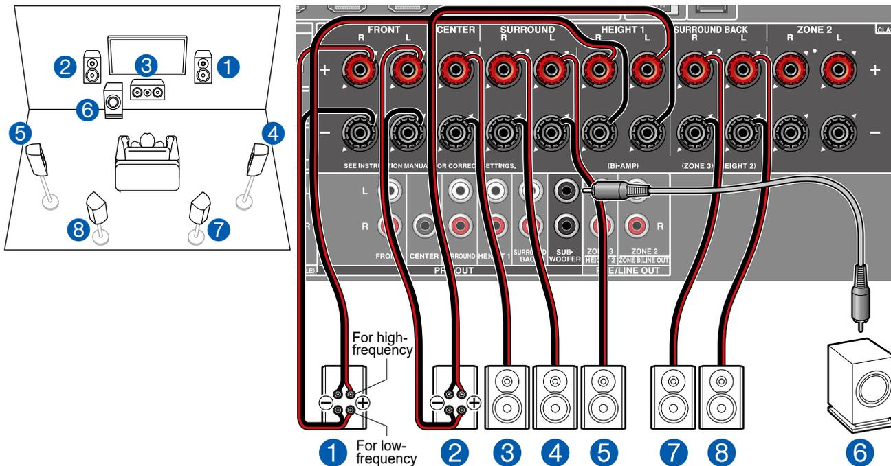
Vous pouvez configurer un système 7.1 (→p20) en raccordant des enceintes avant qui prennent en charge le raccordement de bi-amplification.
