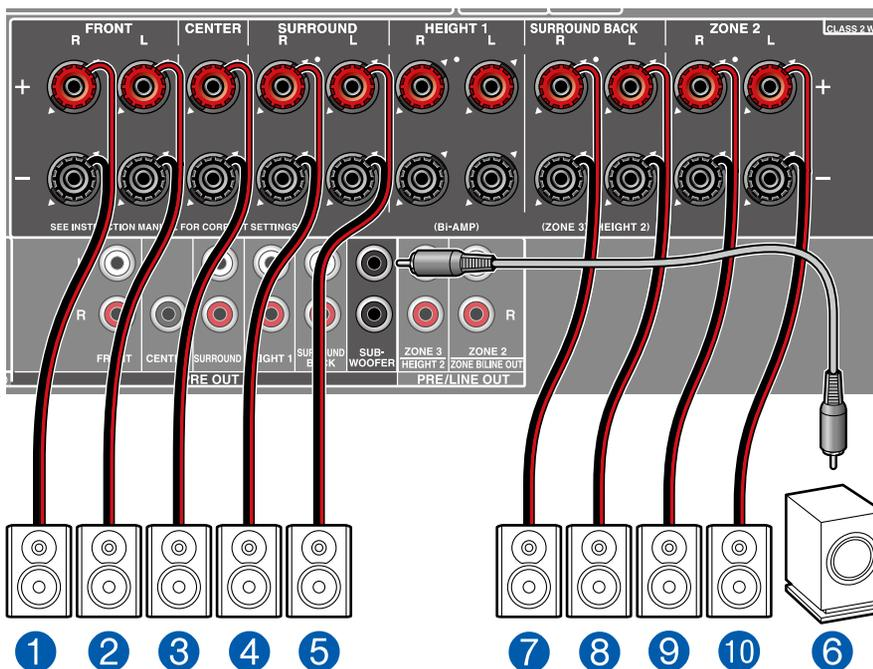
**MAIN ROOM :** Il s'agit d'un système 7.1 constitué du système 5.1 de base auquel ont été rajoutées des enceintes surround arrière. Pour plus de détails sur la disposition d'enceinte, consultez "Installation d'enceintes" (→p20).
