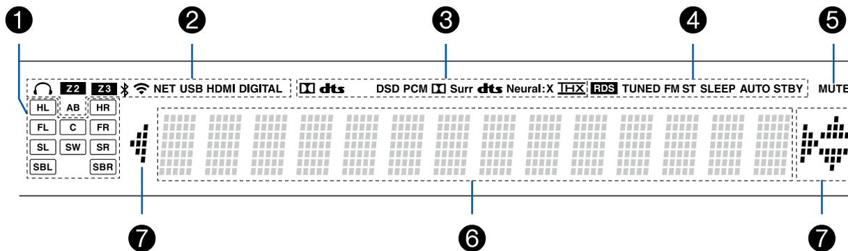
1. Affichage Enceinte/Canal : Affiche le canal de sortie correspondant au mode d'écoute sélectionné.
