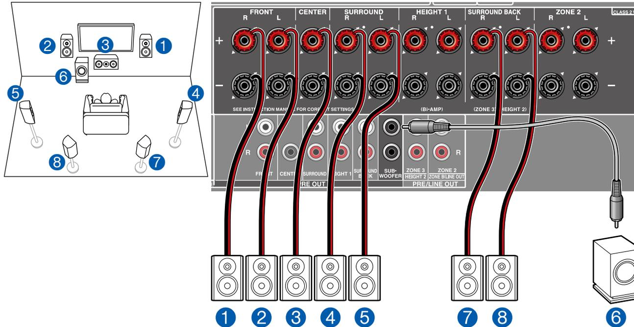
Il s'agit d'un système 7.1 constitué du système 5.1 de base auquel ont été rajoutées des enceintes surround arrière. Pour plus de détails sur la disposition d'enceinte, consultez "Installation d'enceintes" (→p20).
