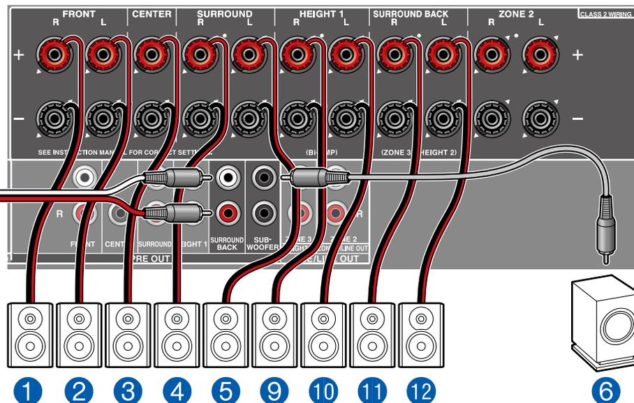
Il s'agit d'un exemple de combinaison d'enceintes pour plafond centrales à l'avant et d'enceintes en hauteur arrière à l'arrière sur le système 7.1. Il est possible de sélectionner les enceintes en hauteur à l'avant parmi les 4 types suivants. Les enceintes en hauteur pouvant être combinées à l'arrière diffèrent selon les enceintes en hauteur utilisées à l'avant.
