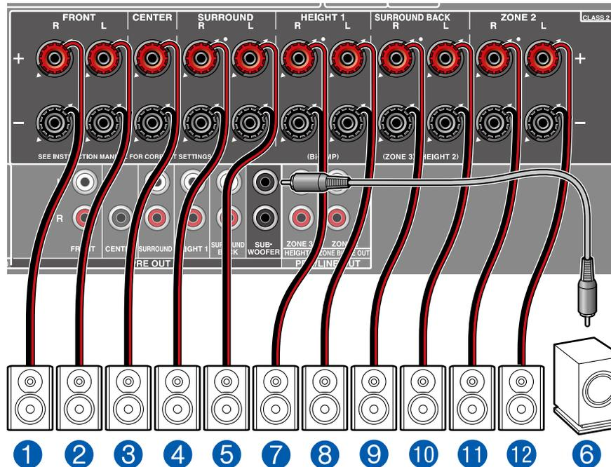
**MAIN ROOM :** Il s'agit d'un exemple de combinaison d'enceintes pour plafond centrales à l'avant et d'enceintes en hauteur arrière à l'arrière sur le système 5.1. Il est possible de sélectionner les enceintes en hauteur à l'avant parmi les 4 types suivants. Les enceintes en hauteur pouvant être combinées à l'arrière diffèrent selon les enceintes en hauteur utilisées à l'avant.
