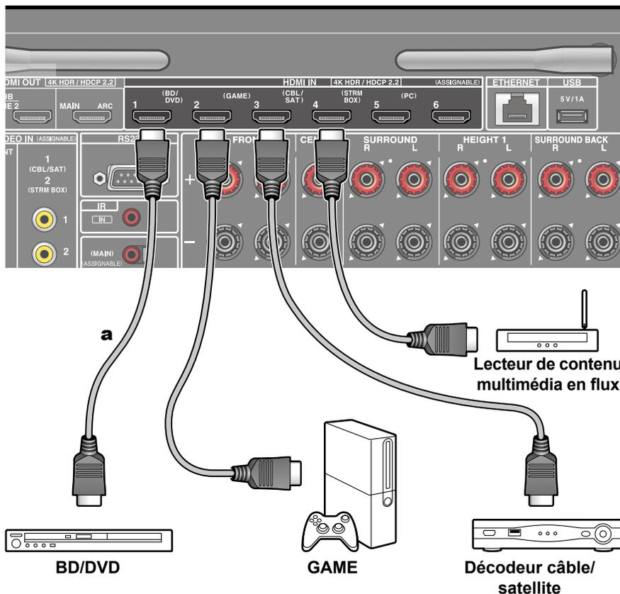
Il s'agit d'un exemple de raccordement avec un appareil AV possédant de prise HDMI. En raccordant un appareil AV conforme à la norme CEC (Consumer Electronics Control), vous pouvez utiliser la fonctionnalité HDMI CEC (\*) qui établit une liaison avec les sélecteurs d'entrée, etc. et la fonctionnalité HDMI Standby Through qui vous permet de transférer les signaux vidéo et audio provenant de l'appareil AV sur le téléviseur même si cet appareil est en veille.
