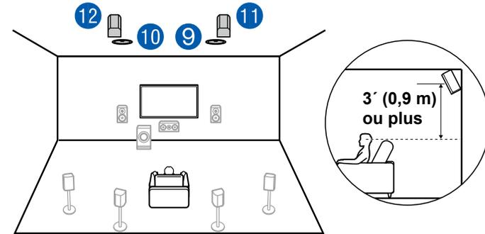
La distance entre les enceintes en hauteur arrière doit correspondre à celle des enceintes avant, et elles doivent être installées avec une élévation d'au moins 3' / 0,9 m de plus que les enceintes avant, et avec une inclinaison de sorte qu'elles pointent vers la personne qui écoute.
