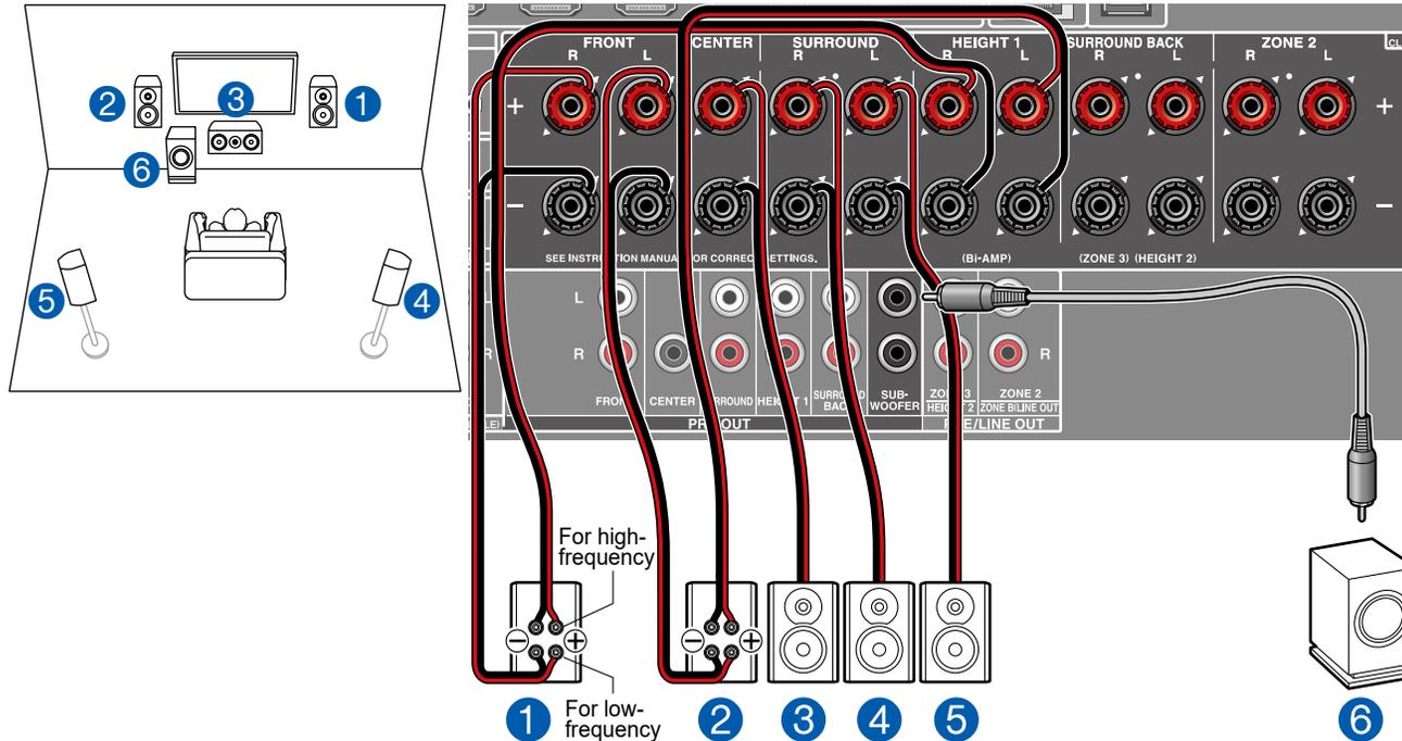
Vous pouvez configurer un système 5.1 (→p19) en raccordant des enceintes avant qui prennent en charge le raccordement de bi-amplification. Le raccordement de bi-amplification peut améliorer la qualité des plages graves et aiguës. Assurez-vous de retirer le cavalier raccordant les prises des graves et les prises des aigus des enceintes qui prennent en charge la bi-amplification. Consultez également le mode d'emploi de vos enceintes.
