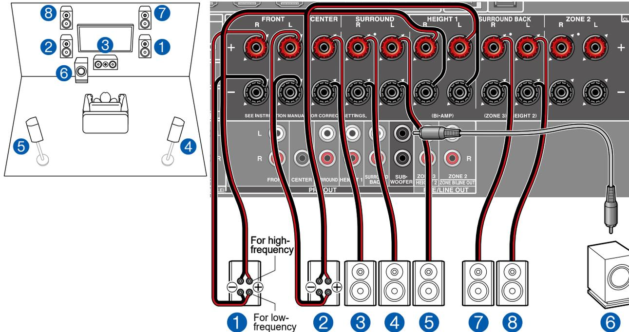
Il s'agit de la combinaison d'un système 5.1 et d'enceintes en hauteur avant. Une enceinte en hauteur avant est un type d'enceinte en hauteur. Vous pouvez sélectionner uniquement un jeu d'enceintes en hauteur parmi les trois types suivants pour le raccordement.
