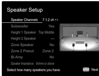
2. La combinaison d'enceintes sélectionnées à l'étape s'affiche 1. "Yes" s'affiche pour les enceintes sélectionnées. Si le réglage est correct, appuyez sur ENTER.
