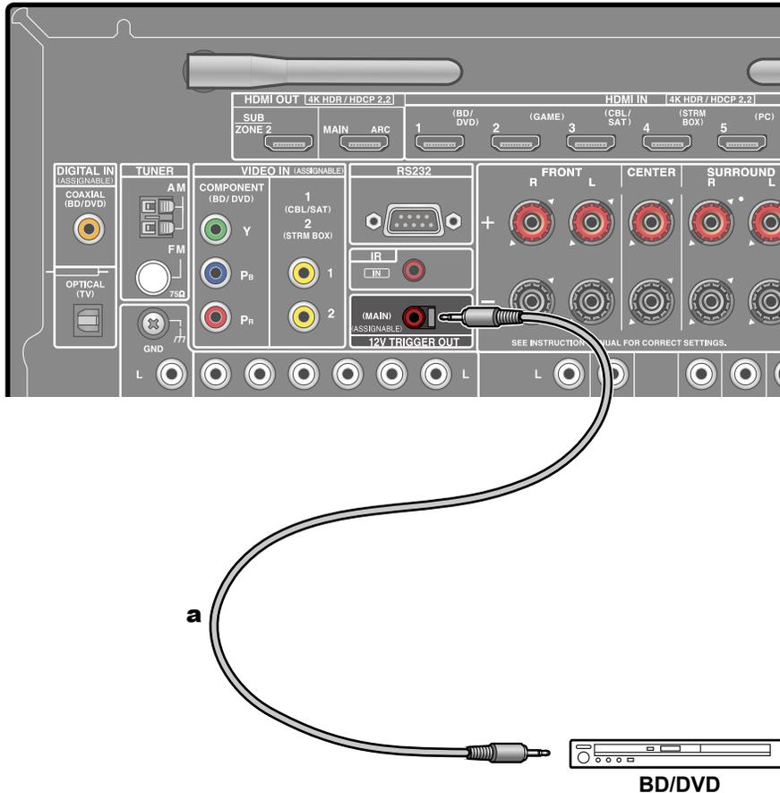
Lors du raccordement à cet appareil d'un périphérique doté d'une prise TRIGGER IN comme un lecteur BD/DVD, il est possible de mettre le périphérique sous tension ou en veille en verrouillant l'utilisation sur cet appareil. Lorsqu'une entrée quelconque est sélectionnée, cet appareil émet un signal de commande de 12 V/100 mA maximum depuis la prise 12V TRIGGER OUT, et contrôle le fonctionnement de la liaison électrique du périphérique externe.
