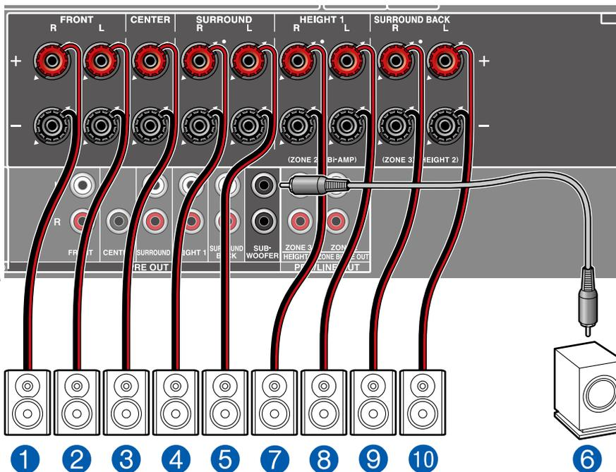
**MAIN ROOM :** Il s'agit d'un système 5.1 de base. Pour plus de détails sur la disposition d'enceinte, consultez "Installation d'enceintes" (→[p19](#)).
