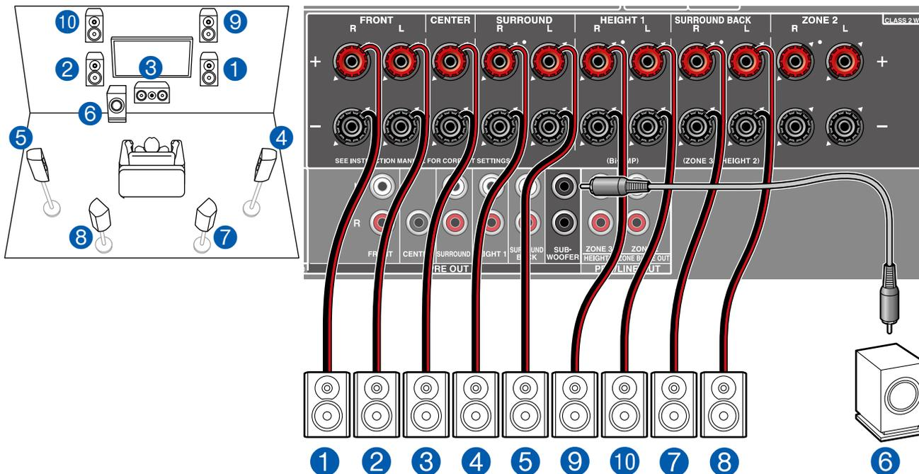
Il s'agit de la combinaison d'un système 7.1 et d'enceintes en hauteur avant. Une enceinte en hauteur avant est un type d'enceinte en hauteur. Vous pouvez sélectionner uniquement un jeu d'enceintes en hauteur parmi les trois types suivants pour le raccordement.
