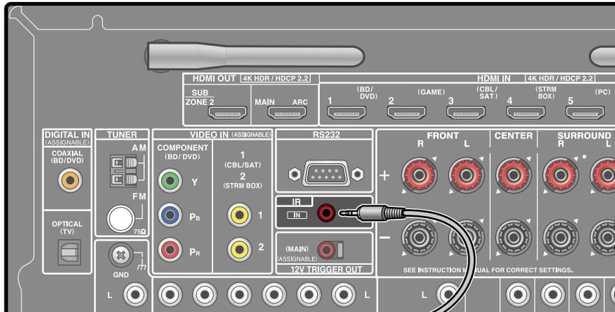
Lors du raccordement d'une unité de réception pour contrôle à distance consistant en un récepteur IR, etc à cet appareil, l'utilisation à l'aide de la télécommande est possible même si le signal de la télécommande est difficile à capter (en raison de l'installation dans un meuble, etc.). Vous pouvez également utiliser l'appareil à l'aide de la télécommande depuis une autre pièce comme ZONE 2. Pour adopter une unité de réception pour contrôle à distance, contactez les magasins spécialisés.
