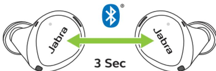
1. Allumez les écouteurs en les retirant de l'étui de recharge. Une autre solution consiste à appuyer simultanément sur les boutons **gauche** et **droit**.
