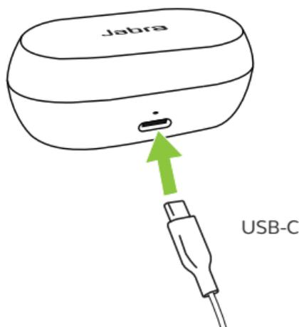
L'étui de recharge utilise une tension USB standard de  $5V \pm 0,25V$ . Nous vous déconseillons de recharger les écouteurs avec une source d'alimentation électrique affichant une tension supérieure.
