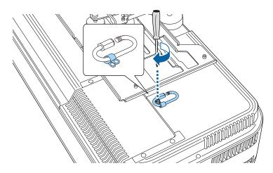
Paites passer les deux extrémités du câble de sécurité dans le mousqueton, puis serrez le verrou du mousqueton.
