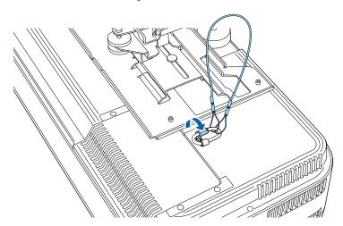
Faites passer l'autre mousqueton dans le trou du bras de la plaque d'installation.
