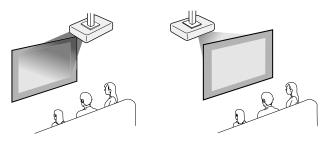
Sélectionnez la bonne option de **Projection** dans le menu **Installation** du projecteur en fonction de la méthode d'installation utilisée. Modifiez si nécessaire le paramètre **Touche invers. sens** dans le menu **Fonctionnement** du projecteur.
