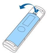
Retirez les piles usagées si nécessaire.
