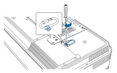
2 Enroulez le câble de sécurité à travers le trou sur le support plafond et fixez les deux extrémités au mousqueton.
