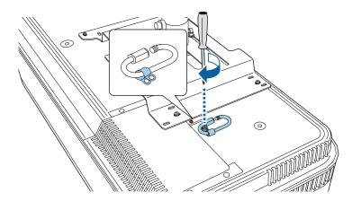
Enroulez le câble de sécurité autour de la tige de support du support plafond et fixez les deux extrémités au mousqueton du projecteur.
