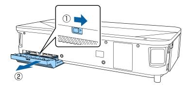
Retirez le filtre à air du couvercle du filtre à air.
