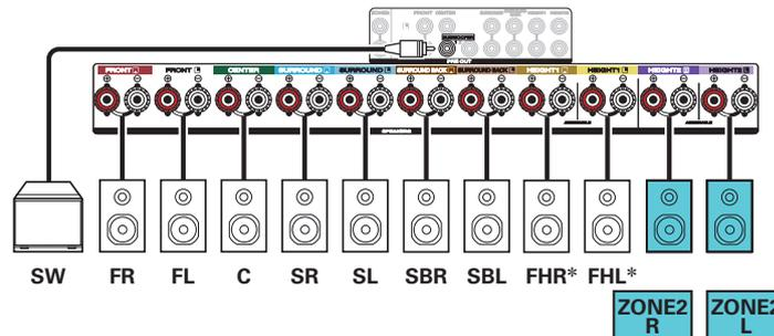
\* Les enceintes hautes, les enceintes au plafond et les enceintes Dolby Atmos Enabled peuvent être connectées sur les bornes d'enceinte HEIGHT1. Réglez les enceintes à connecter depuis "Hauteur" - "Agencement" dans le menu. (☞ p. 216)
