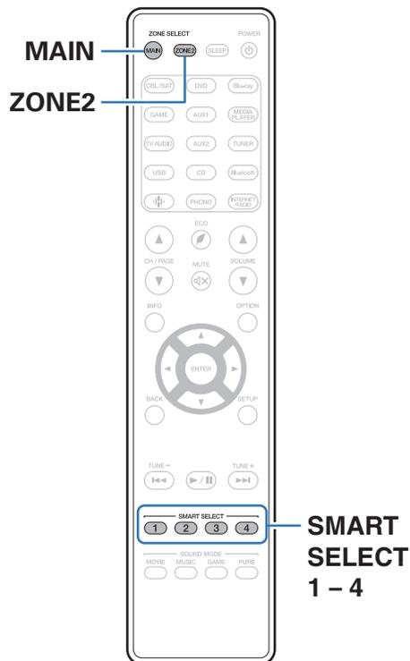
Vous pouvez enregistrer les différentes réglages (sélection de la source d'entrée, volume, mode audio, etc.) à l'aide des boutons SMART SELECT 1 – 4.
