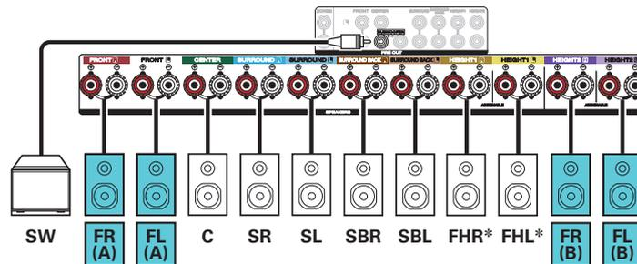
\* Les enceintes hautes, les enceintes au plafond et les enceintes Dolby Atmos Enabled peuvent être connectées sur les bornes d'enceinte HEIGHT1. Réglez les enceintes à connecter depuis "Hauteur" - "Agencement" dans le menu. (☞ p. 216)
