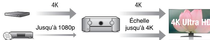
Cet appareil est équipé d'une fonction de vidéo ascendante 4K qui permet à la vidéo analogique ou vidéo SD (Standard Definition) d'être émise en résolution HDMI à 4K (3840 × 2160 pixels). Cette fonction permet à l'appareil d'être connecté à un téléviseur à l'aide d'un simple câble HDMI, et de produire des images en haute définition pour n'importe quelle source vidéo.
