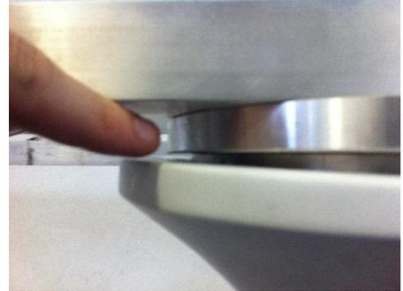
**STEP 2** – appliquer la caisse esthétique postérieure. Suivre la position du trou dans le support pour l'introduction de la vis. Serrer la vis en place tandis qu'on applique une légère pression à la base de la caisse même. Serrer fermement mais pas excessivement.
