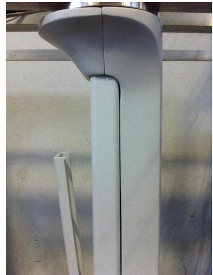
**STEP 3** – effectuer tous les contrôles d’alignement des caisses. Vérifier le correct parallélisme entre la caisse antérieure et celle postérieure. S’assurer que les caisses soient entièrement en contact avec la colonne : aucune fuite excessive ni inclinaison doivent être présentes. Contrôler tout désalignement esthétique, en le corrigeant, si possible.
