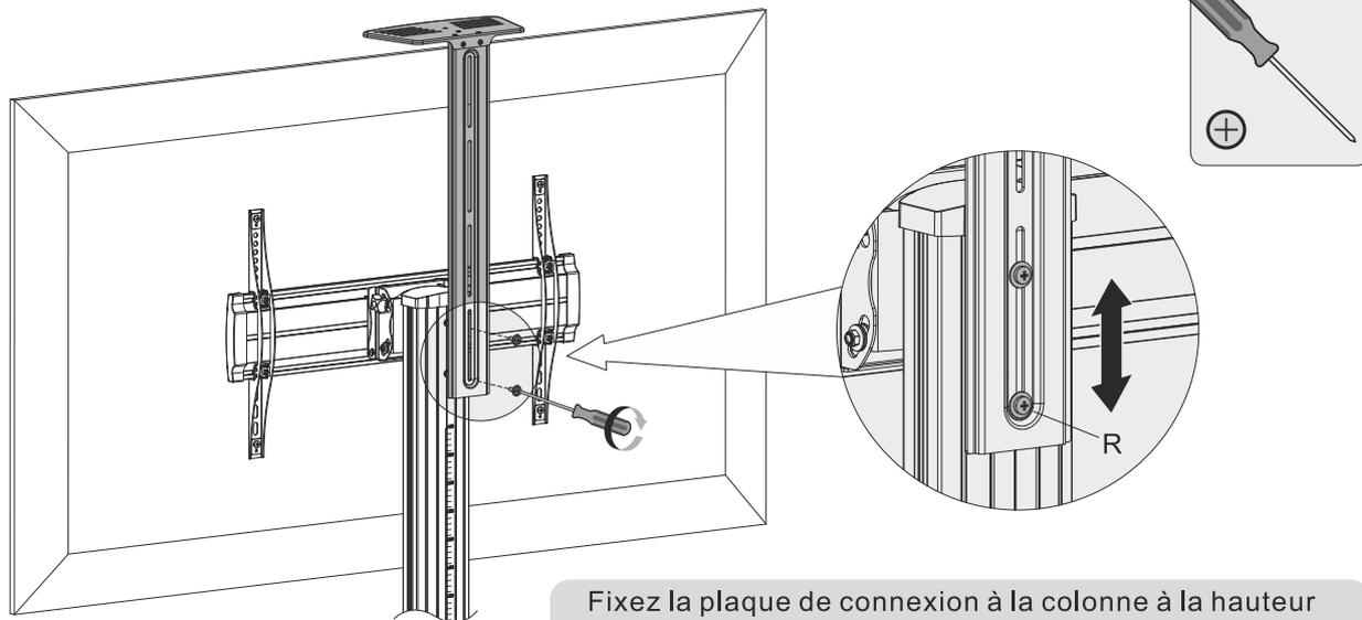
Fixez la plaque de connexion à la colonne à la hauteur souhaitée en utilisant les vis appropriées. Serrez toutes les vis à l'aide d'un tournevis approprié.
