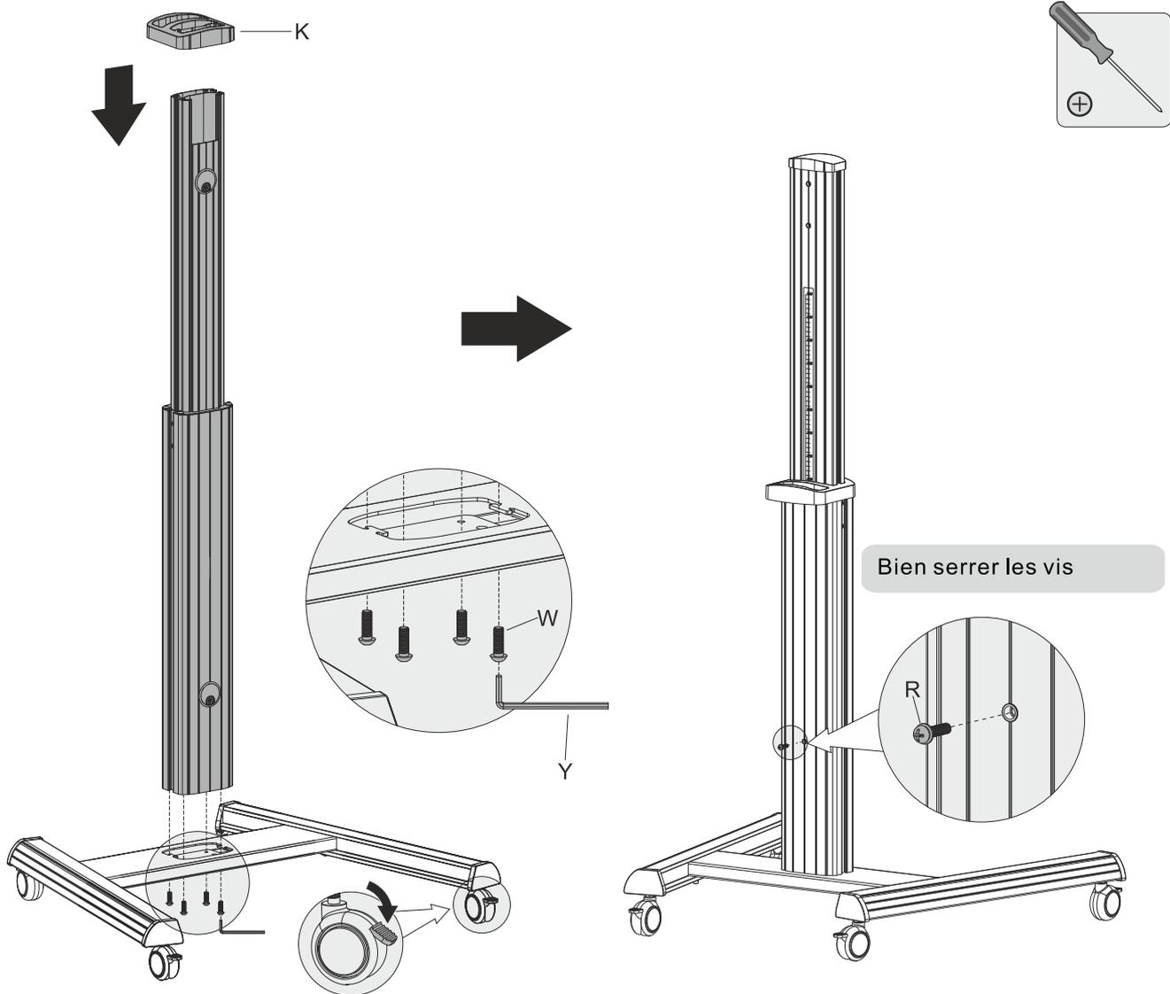
Fixez la colonne à la base à l'aide des vis. Serrez toutes les vis à l'aide d'une clé Allen.
