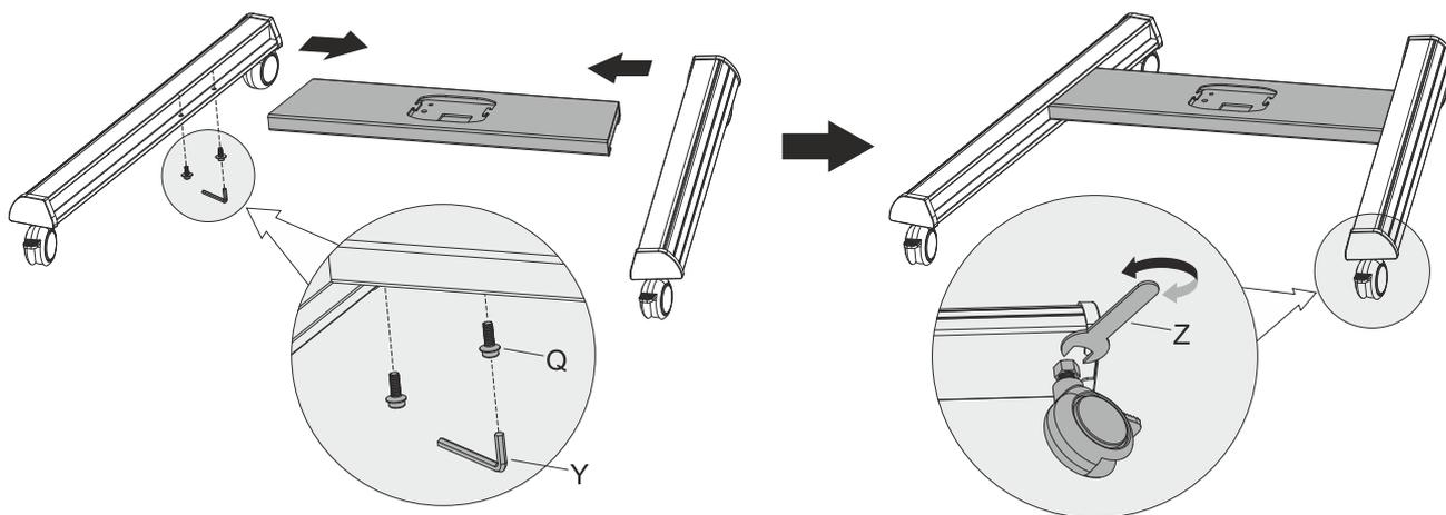
Insérez le pied droit dans la base. Alignez les trous du pied droit vers les trous de la base. Fixez avec les vis. Répétez cette étape pour le pied gauche. Chaque roulette peut être réglée indépendamment pour un réglage précis. Tournez légèrement l'écrou pour baisser ou monter la base.
