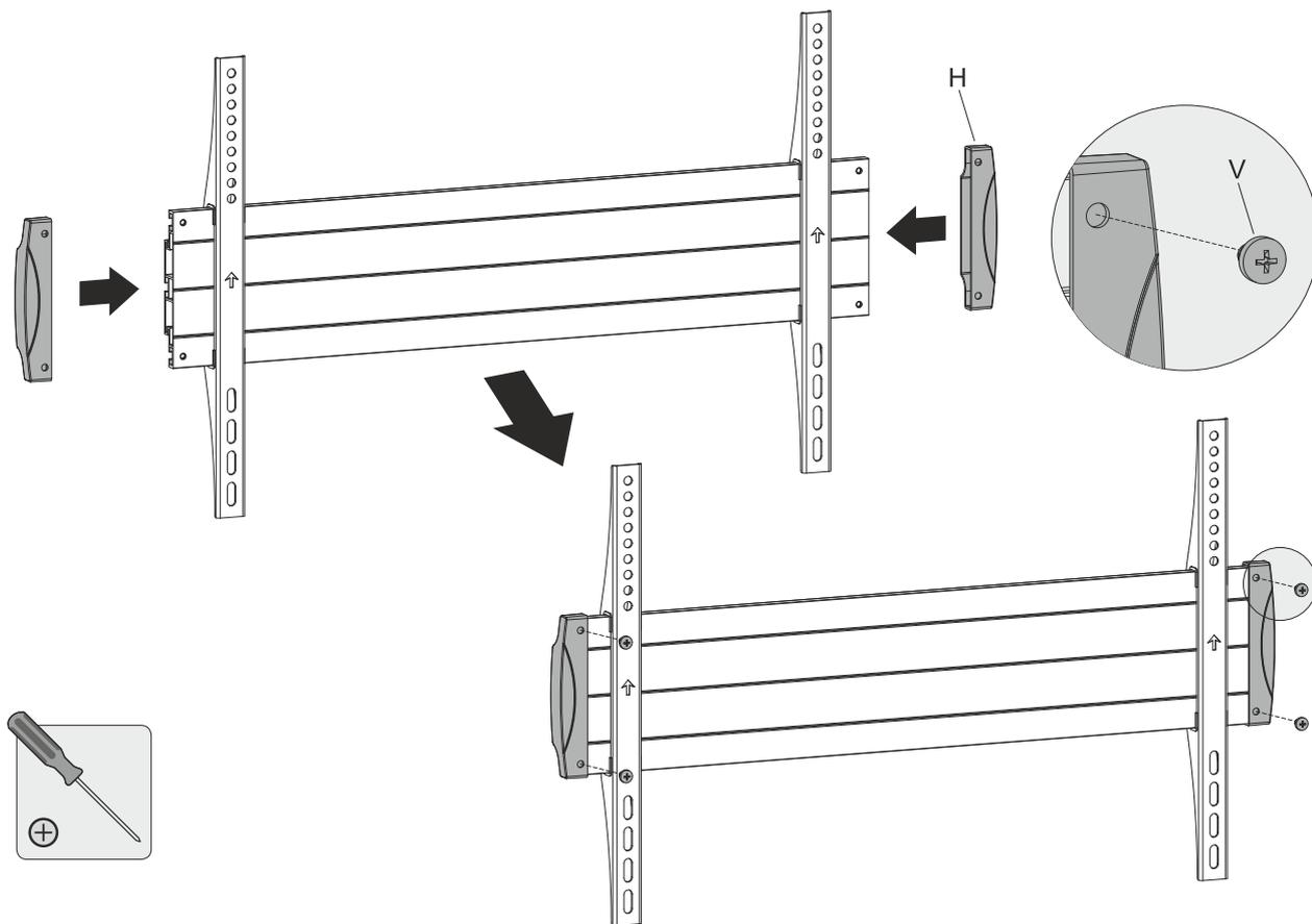
Fixez les deux couvercles en plastique aux deux extrémités de la plaque en utilisant les vis appropriées. Serrez toute la vis à l'aide d'un tournevis approprié.
