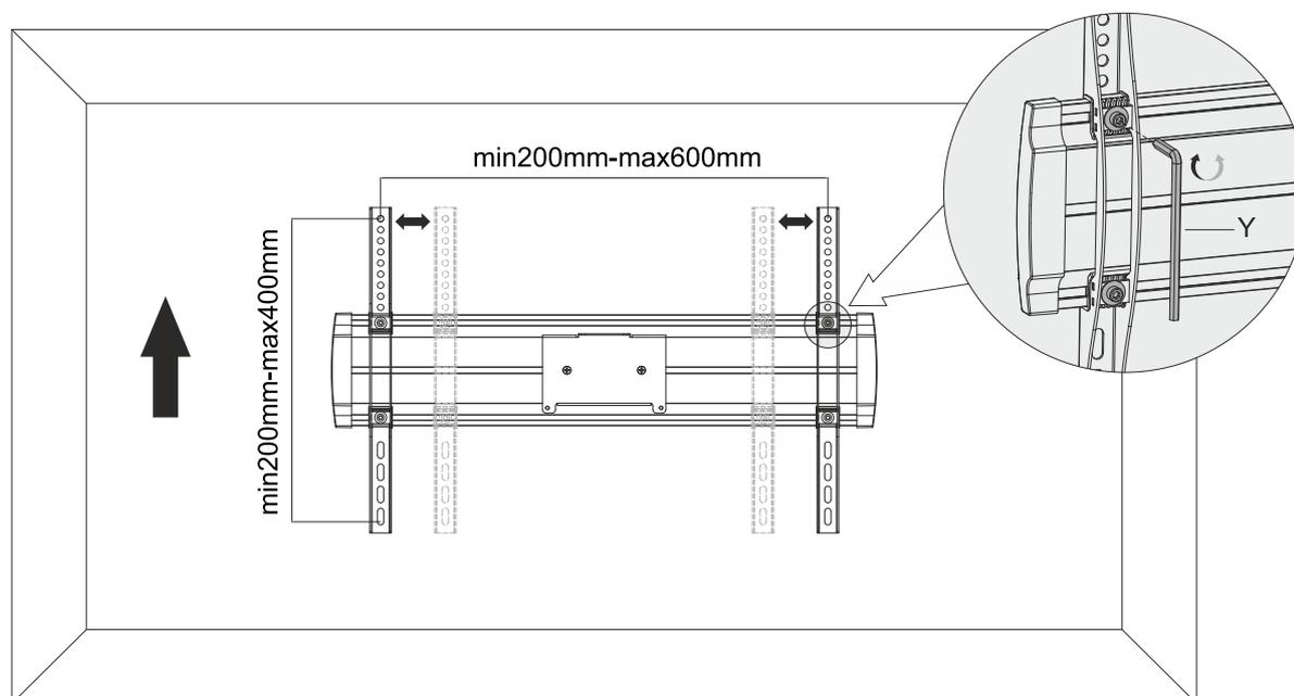
Réglez les pattes de fixation pour s'adapter à la configuration des trous de votre écran. Ensuite, serrez toutes les vis avec une clé Allen.
