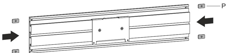
Insérez les rondelles à l'arrière de la plaque universelle le long des rails de la plaque..
