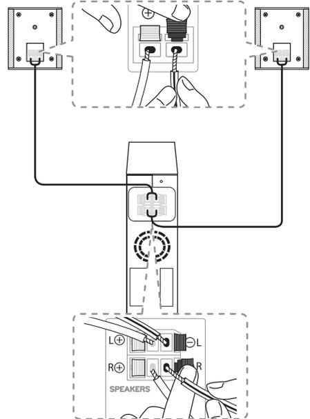
2. Connectez le récepteur sans fil et les enceintes arrière (gauche, droite) aux câbles des enceintes.
