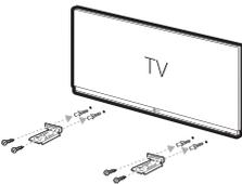
5. Placez l'unité sur les supports de sorte qu'elle soit alignée avec les trous en dessous de l'appareil.
