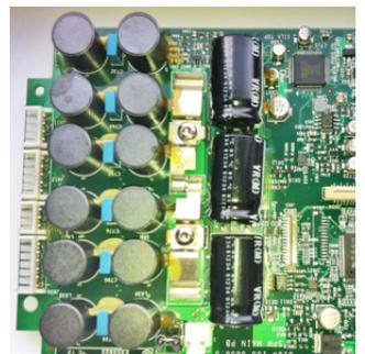
Ci-dessus : Prototype de la carte électronique regroupant l'ensemble des fonctions en-dehors de l'alimentation. A noter sur la gauche les douze ferrites des filtres de sortie. Au centre trois condensateurs apportent une réserve d'énergie pour gérer les crêtes de modulation.
