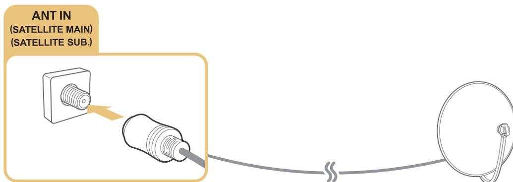
Il est préférable de relier les deux connecteurs à l'aide d'un commutateur multiple ou d'un commutateur DiSEqC, etc. et de définir **Type de connexion d'antenne** sur **Double oscillateur**.
