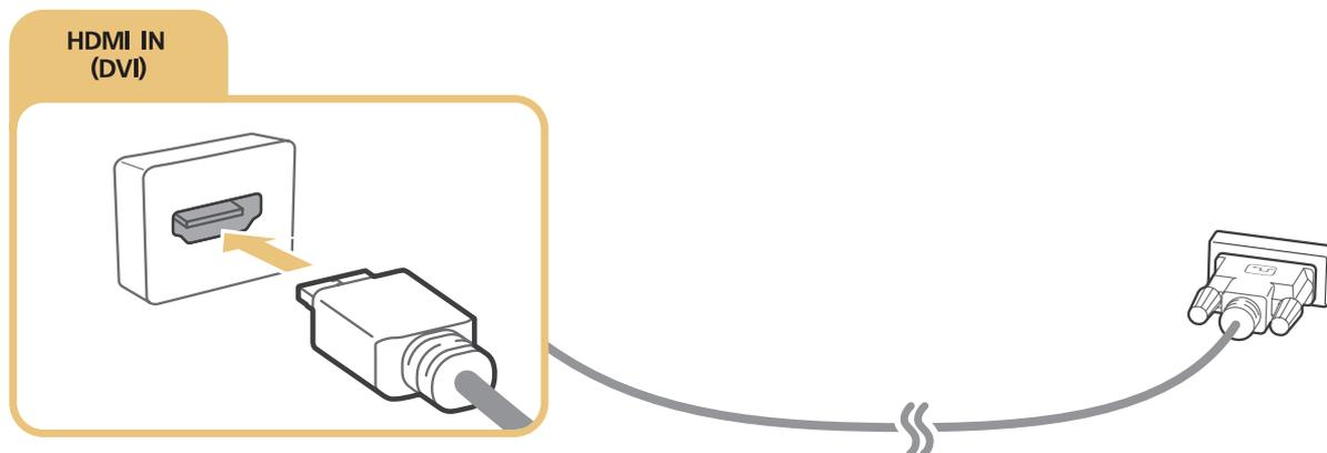
✎ Définissez **Modifier le type de périphérique** sur **DVI PC** pour un ordinateur connecté à l'aide d'un câble HDMI vers DVI, et sur **PC** pour un ordinateur connecté à l'aide d'un câble HDMI. Ensuite, définissez **Modifier le type de périphérique** sur **Périph. DVI** pour un périphérique A/V connecté à l'aide d'un câble HDMI vers DVI.
