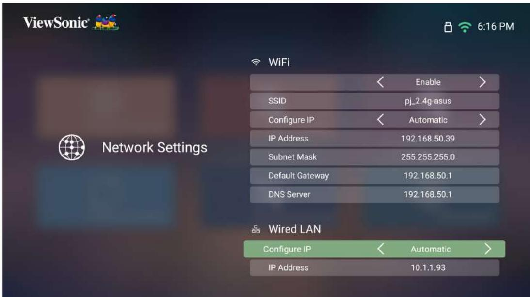
3. Vous pouvez configurer l'adresse IP automatiquement ou manuellement. Choisir **Manual (Manuel)** permet d'accéder à **IP Address (Adresse IP)**, **Subnet Mask (Masque de sous-réseau)**, **Default Gateway (Passerelle par défaut)** et **DNS Server (Serveur DNS)**.
