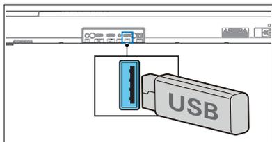
2 Appuyez plusieurs fois sur le bouton
