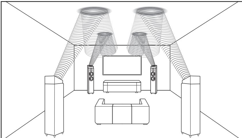
Commencez par positionner vos enceintes Monitor IX dans votre pièce. Espacez les enceintes de 25-30cm du mur, et orientez-les légèrement vers votre zone d'écoute. Placez ensuite les Monitor ATM sur les colonnes.
