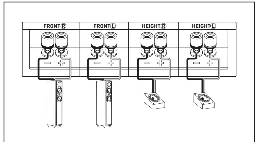
Reliez les entrées de vos Monitor ATM au bornes FRONT HEIGHT (ou PRESENCE) de votre amplificateur. Puis, reliez les entrées MAIN de vos Monitor IX au bornes FRONT (ou MAIN) de votre amplificateur.
