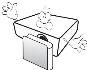
7. La lampe atteint une température très élevée lorsque l'appareil est en cours d'utilisation. Attendez que le projecteur ait refroidi (environ 45 minutes) avant de retirer la lampe pour la remplacer.
