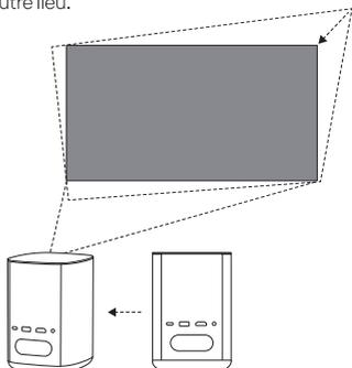
Lorsque la fonction d'évitement automatique des obstacles est activée, l'image évite automatiquement les obstacles qui obstruent la zone de projection. Lorsque la fonction d'alignement automatique de l'écran est activée, l'image s'adapte automatiquement au format d'image 16:9 ou 16:10.
