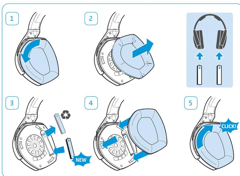
**i** Vous pouvez également alimenter le casque avec des piles standard (type AAA, 1,5 V). Veuillez noter que des piles standard ne peuvent pas être rechargées et, si vous utilisez des piles standard, veuillez à ne pas ne placer le casque sur le support casque de l'émetteur.
