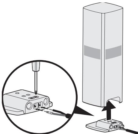
3. Utilisez le tournevis cruciforme pour fixer les fils aux bornes en serrant les vis sur la partie supérieure de la base dans le sens des aiguilles d'une montre (vers la droite).
