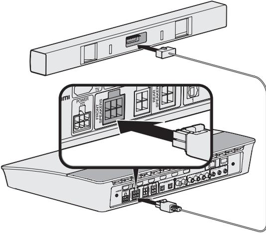
4. Insérez la fiche moulée du câble à six broches dans le connecteur **FRONT SPEAKERS** à six broches à l'arrière de la console.
