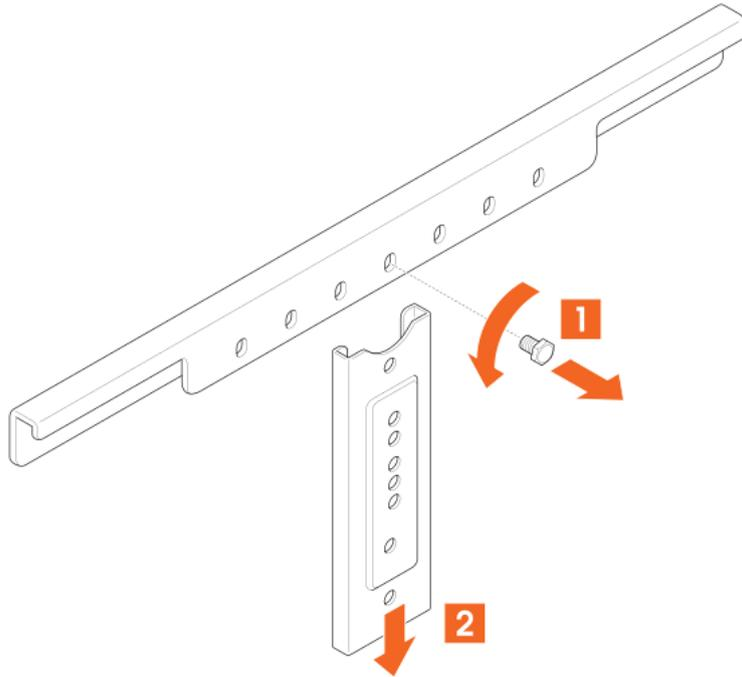
5. Desserrez le boulon qui relie la barre horizontale supérieure au(x) support(s) vertical/verticaux. Retirez le(s) support(s) vertical/verticaux.
