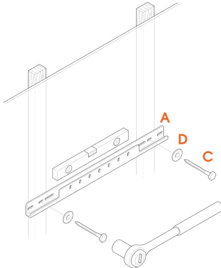
7. Fixez la **barre horizontale** <sup>Ⓐ</sup> inférieure au mur en bois à l'aide des **vis** <sup>Ⓒ</sup> et des **rondelles** <sup>Ⓓ</sup> du kit de montage.
