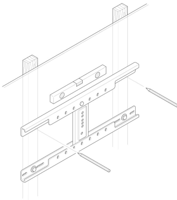
2. Utilisez le niveau à bulle pour niveler la barre horizontale supérieure. Marquez les trous de perçage
