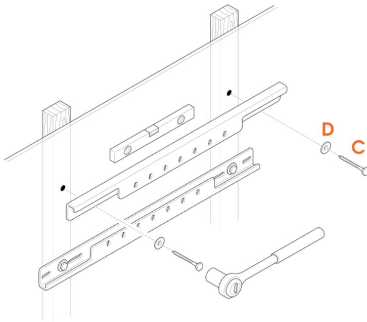
6. Fixez la barre horizontale supérieure au mur en bois à l'aide des **vis** © et des **rondelles** © du kit de montage.
