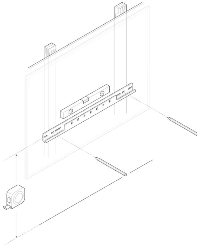
4. Déterminez la hauteur de votre adaptateur de montants et marquez les trous de perçage à l'aide de la barre horizontale inférieure.
