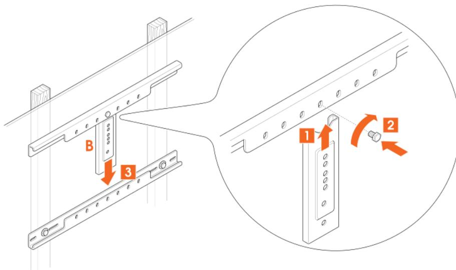
1. Fixez la barre horizontale supérieure au(x) **support(s) vertical/verticaux** ® . Placez temporairement l'ensemble dans la barre horizontale inférieure.
