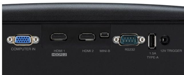
Le LX-UH1 est compatible avec une source 4K et jusqu'à 18Gbps de débit (en 4K / 60p 4: 4: 4 / 36bit, 4K / 60p 4: 2: 2 / 36bit, ou 4K / 24p 4: 4: 4 / 36bit) afin d'avoir des couleurs vives et des gradations subtiles. De plus, la compatibilité HDCP2.2 signifie que ce projecteur peut fonctionner avec les contenus protégés par des droits d'auteur comme les services de streaming ou les disques Blu-ray UHD.
