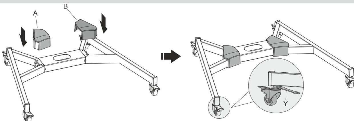
**NOTE:** Bloquer les freins sur les roulettes pour éviter les faux mouvements pendant l'installation.
