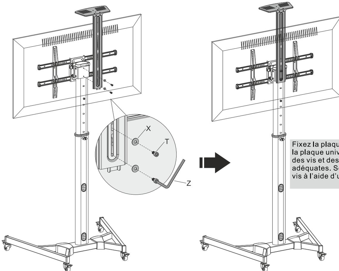
Fixez la plaque de raccord à la plaque universelle avec des vis et des rondelles adéquates. Serrez toutes les vis à l'aide d'une clé Allen.
