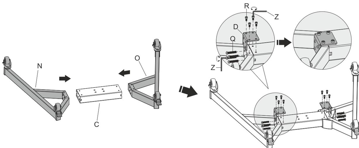
Insérez la base de droite dans la base centrale. Alignez les trous de la base de droite aux trous de la base centrale. Fixez les avec les vis et les plaques de raccord. Répétez cette étape pour la base de gauche.
