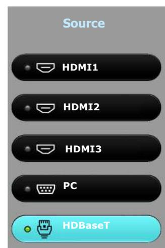
Une fois le signal détecté, les informations concernant la source sélectionnée s'affichent dans le coin de l'écran pendant quelques secondes. Si plusieurs appareils sont connectés au projecteur, répétez les étapes 1-2 pour rechercher un autre signal.
