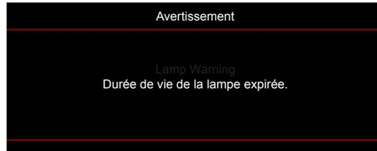
Lorsque ce message apparaît, veuillez contacter votre revendeur local ou votre centre de service afin de remplacer l'ampoule le plus rapidement possible. Avant de remplacer l'ampoule, veuillez à éteindre le projecteur et débrancher le cordon d'alimentation. Assurez-vous que le projecteur a refroidi pendant au moins 30 minutes et que l'ampoule est complètement refroidie.
