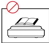
Aucun objet ne doit être placé au-dessus ou devant la lentille, car la lumière laser chaufferait alors fortement l'objet. Risque d'incendie !
