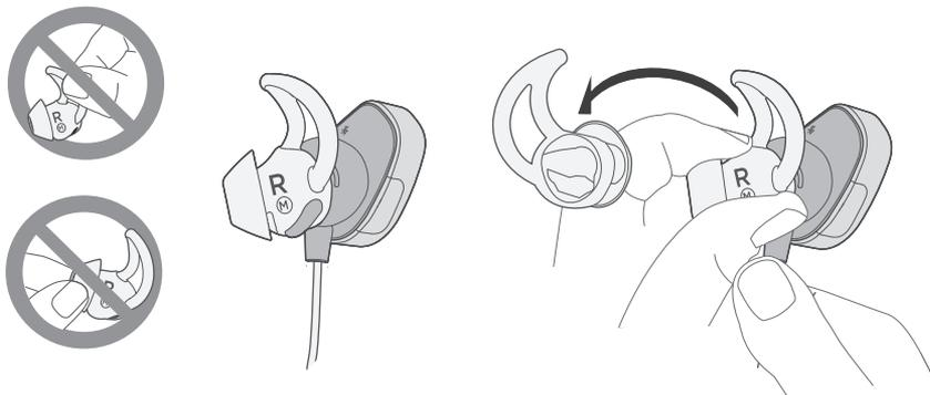
2. Alignez l'ouverture du nouvel embout StayHear®+ Pulse avec la canule de l'écouteur et faites pivoter l'embout dans cette dernière.
