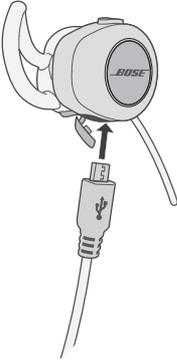
3. Raccordez l'autre extrémité du câble à un chargeur USB mural ou au port USB d'un ordinateur sous tension.
