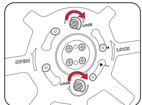
Orientez et alignez le bras du support avec le moniteur, puis poussez pour les rapprocher jusqu'à un déclic et leur verrouillage en place.
